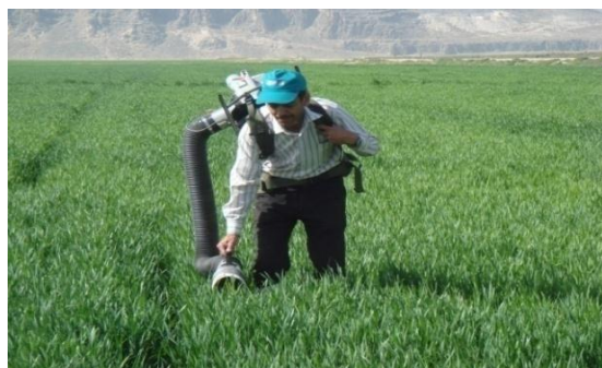
شکل ۳- دستگاه مکش برای جمع‌آوری بندپایان اندام هوایی گندم (اصلی).
